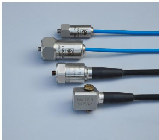
Mjerenja mehaničkih vibracija (apsolutna ubrzanja) na strojevima.
